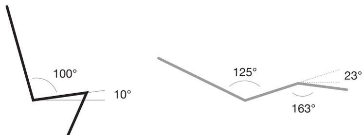
Assise, dossier et repose-jambes réglables (2 moteurs), avec correction d'assise. Repose-jambes réglable séparément. Au choix : avec adaptateur au sol ou batterie permanente rechargeable.
