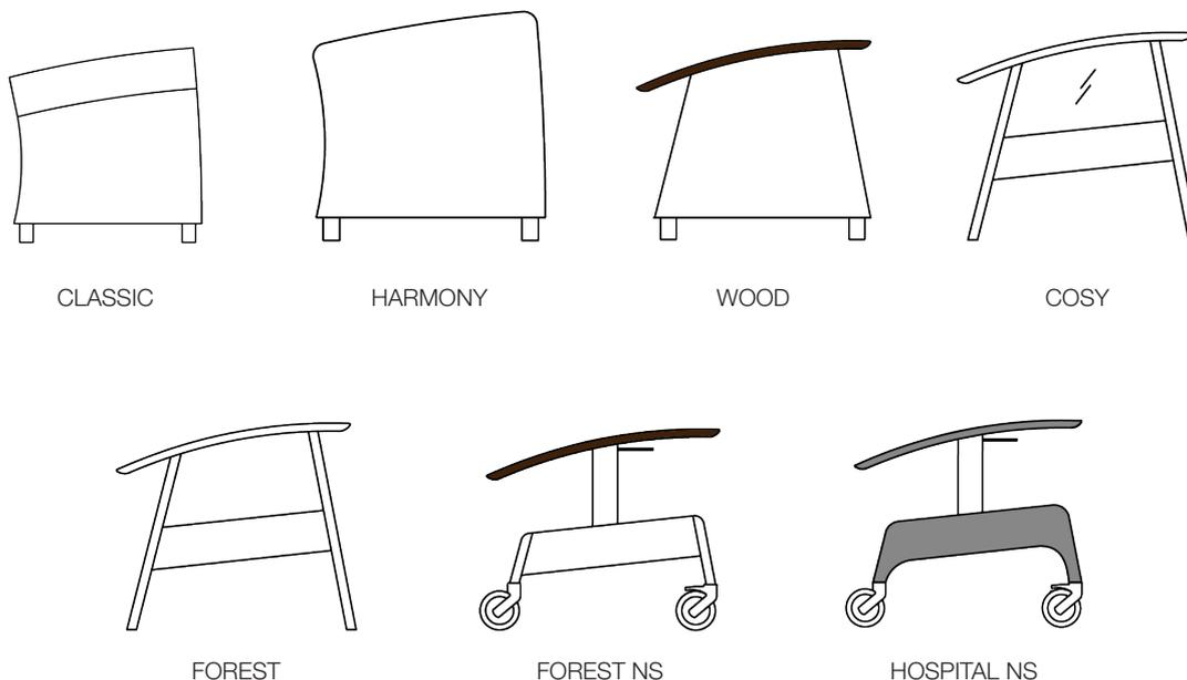
**Cadre** Mécanisme en acier, finition époxy. Les versions suivantes sont disponibles, fixes (non mobiles), mobiles avec 4 roues Ø 75 mm, mobiles avec 4 roues Ø 125 mm ou 4 roues Ø 125 mm ou 4 roues Ø 125 dont 2 sont équipées d'un frein centralisé. En option sur les modèles équipés de roues : repose-pieds escamotable et poignée de poussée.
