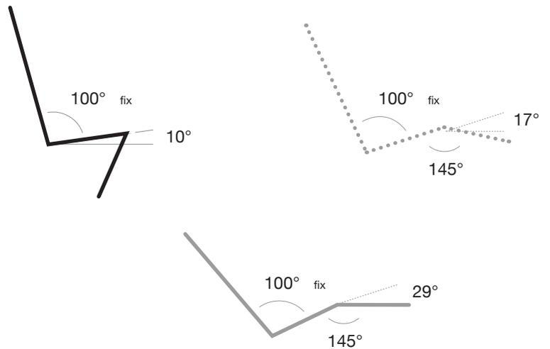
L'assise et le dossier peuvent être facilement réglés, inclinaison fixe. Repose-jambes escamotable automatiquement.
